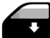
Use **DNK SILICONE AEROSSOL** para lubrificar as canaletas e maquinárias de vidros elétricos ou manuais. Torne o processo de abrir e fechar os vidros mais suaves e com menor esforço, aumentando a vida útil dos equipamentos.
